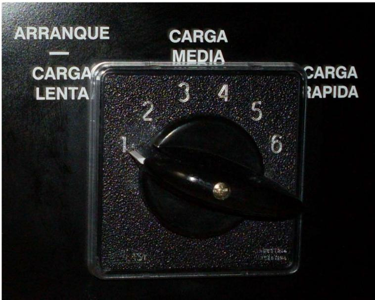
Con respecto a la carga de baterías , los puntos se seleccionan de acuerdo a su estado . Una batería con muchos años de uso cargará lentamente porque tiene una mayor resistencia interna debida al envejecimiento químico. En ese caso necesariamente hay que elevar los puntos , hasta que visualizamos en el display que la corriente de carga es adecuada.
