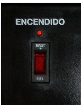
En la posición OFF el equipo está apagado , pero si está conectado a 220V , la llave se ilumina , indicando que hay alimentación. En la posición RESET se enciende el equipo , como lo demuestra el led. Si se superan los 10 amperes de corriente de entrada ( en caso de cortocircuito ) la llave se desconecta automáticamente ( como una llave térmica) . Se puede volver a usar reseteando , siempre corrigiendo antes el motivo del cortocircuito
